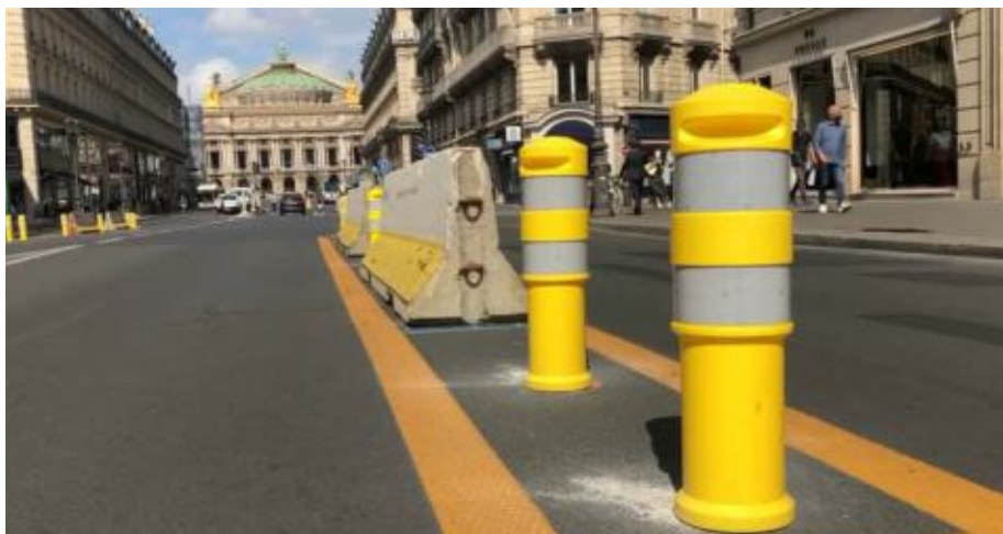
Fig 14. Une coronapiste à Paris, avec ses blocs de béton et ses balisettes de chantier. Photo : BFMTV.
