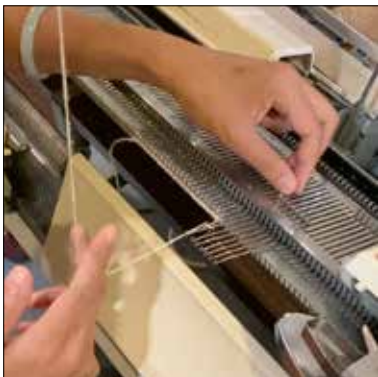
[Fig. 3] Captures d'écran de la vidéo du montage des premières mailles sur la machine à tricoter.
