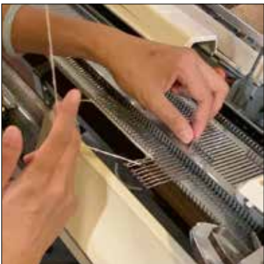
[Fig. 3] Captures d'écran de la vidéo du montage des premières mailles sur la machine à tricoter.
