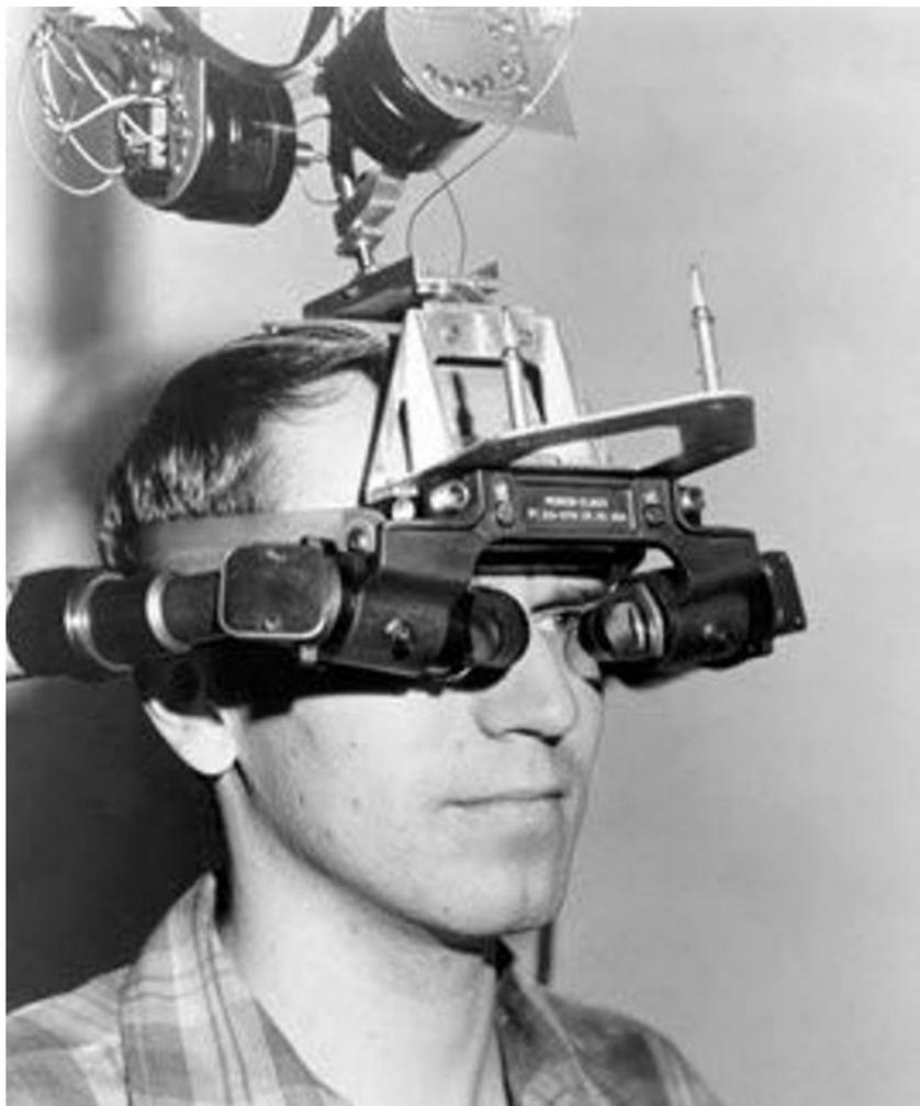
Prototype de *Head Mounted Display*, créé par Ivan Sutherland en 1968. Ce prototype est aussi surnommé «*The sword of Damocles*».
